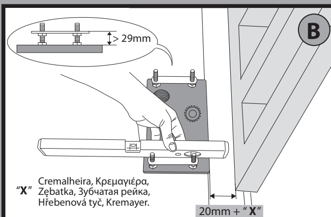
Disposição fixação motor, Προετοιμασία στερέωσης μοτέρ, Przygotowanie do zamocowania silnika, Установка крепления двигателя, Příprava upevnění motoru, Motor sabitleme hazırlığı.
