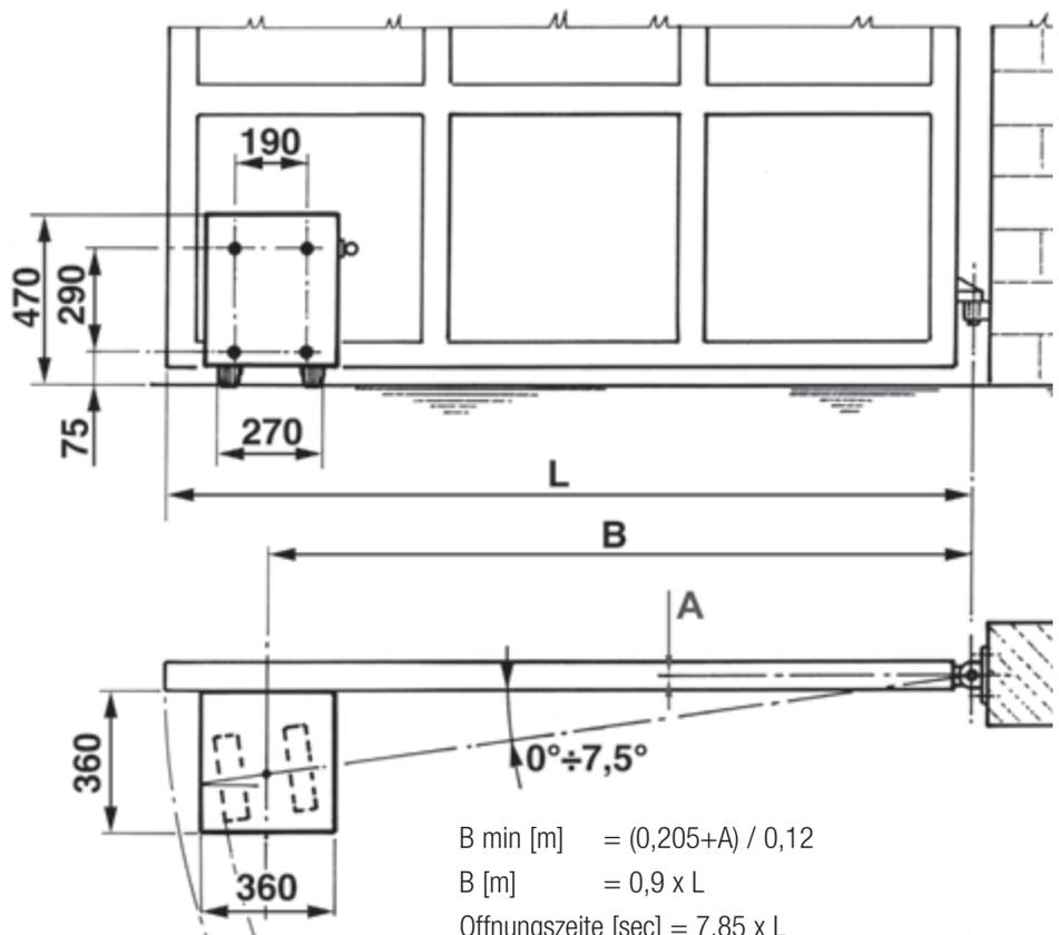
**ANWENDUNG R50 BEI TOREN MIT MEHREREN SCHIEBEFLÜGELN**
